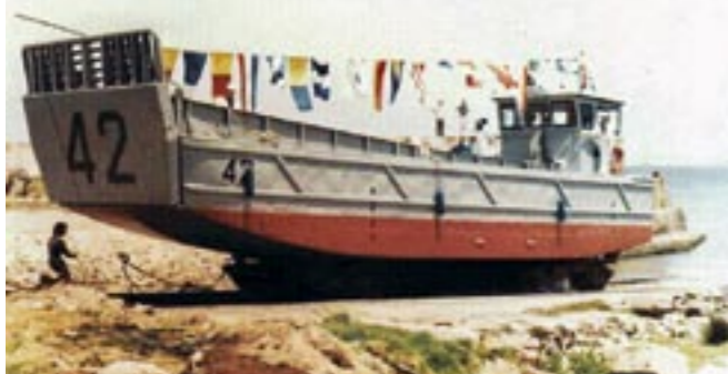
La LD-42 est une barge de plus petite taille construite en Uruguay qui est entrée en service en 1978 et peut embarquer jusqu'à 10 tonnes de matériel.
